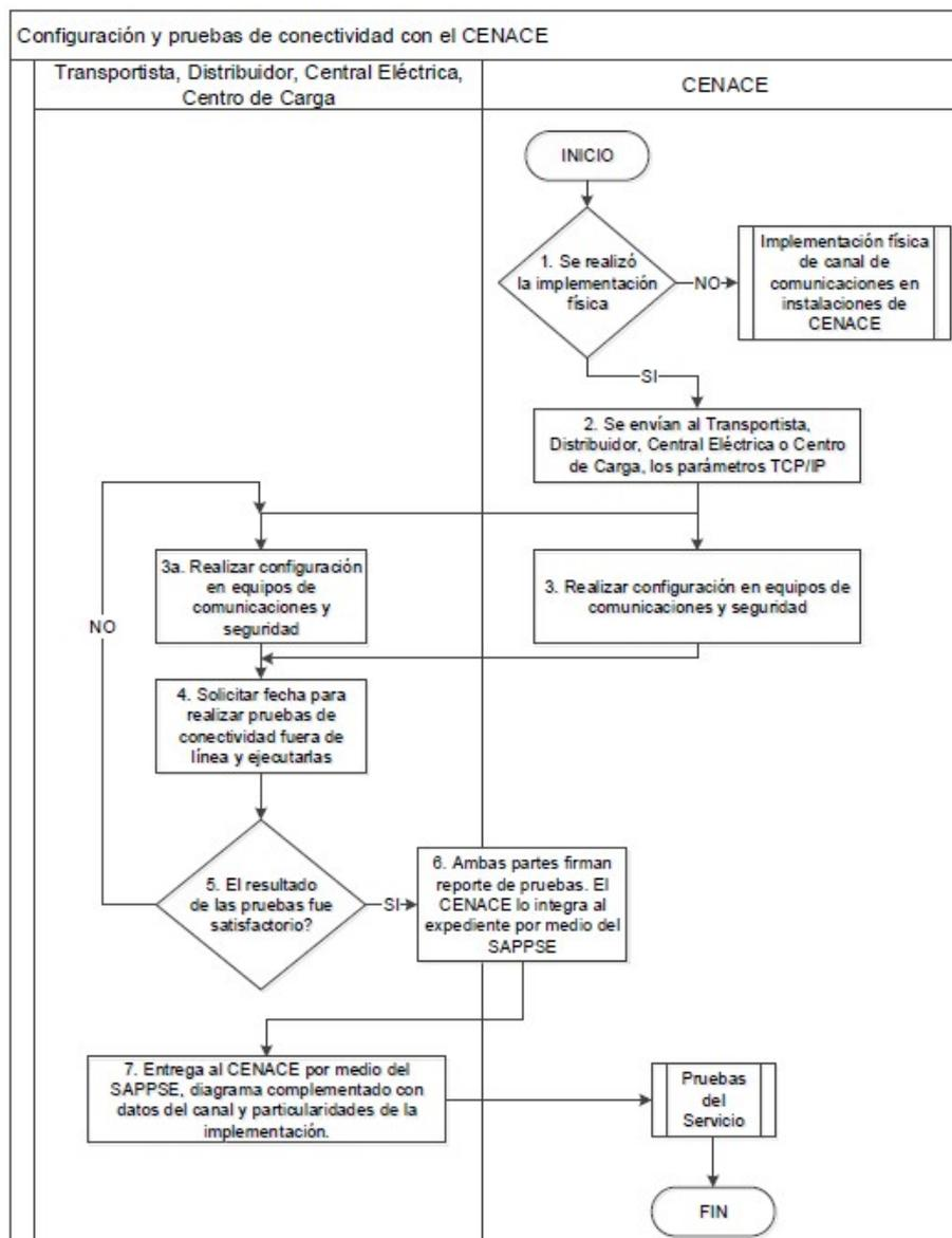
**Figura 2. Proceso de configuración y pruebas de conectividad.**
