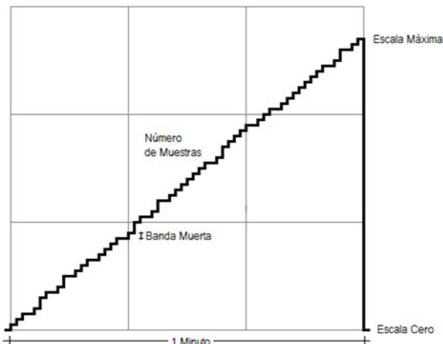
Figura 9 – Ejemplo de rampa analógica de un minuto.
